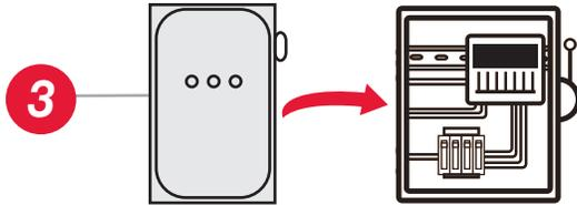
**3** WIRE CONTROL TO MAIN POWER (L1, L2, GND)
